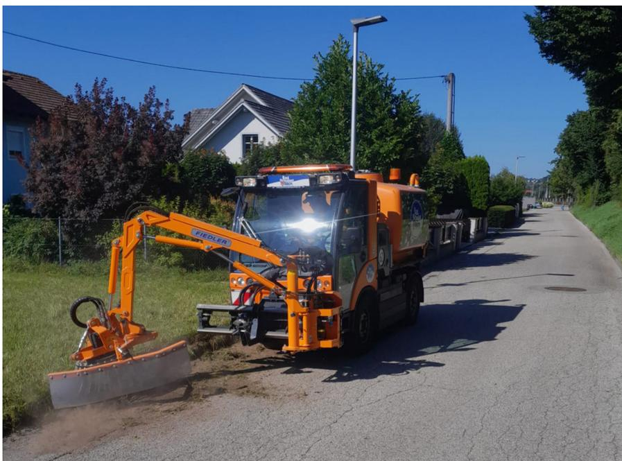
Mit dem Ankauf (Ersatzbeschaffung) des Kommunalfahrzeuges „Tremo Multicar“ wurde neben der Ausrüstung eines Schneepfluges und eines Schneidegerätes für Arbeiten im Strauch- und Heckenbereich auch eine sogenannte „Unkrautbürste“ für die Bekämpfung des Unkrautproblems angeschafft. Diese mechanische Beseitigung ist auch deshalb so wichtig, da sie künftig die einzige Bearbeitungsmethode zur Unkrautbekämpfung darstellt. Sie befindet sich bereits im Einsatz und hat sich bestens bewährt.
